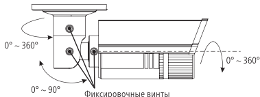
Рис. 6 Регулировка угла обзора камеры FC19W|FC29W|FC59WX
