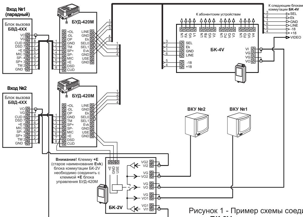
Рисунок 1 - Пример схемы соединений блока коммутации **БК-2V** в составе видеодомофона **VIZIT** серии 400
